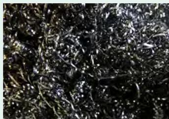
Viruta de acero al carbón generada en el proceso de maquinado de piezas de acero, libre de polvo, tierra húmeda y calamina.
