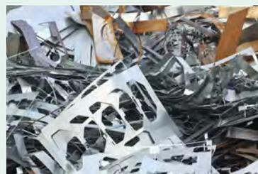
Chatarra proveniente de láminas y sus excedentes, con un espesor menos a 1/4 de pulgada (6,35 mm). Es material de bajo residual, de coloración gris claro y algo brillante por proceder de láminas en frío.
